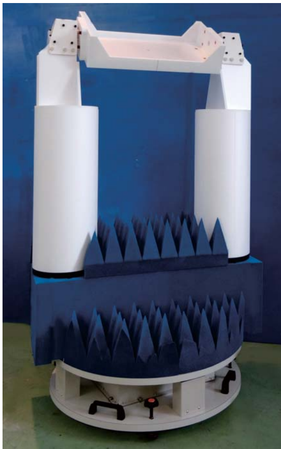
DW3331NDO 球面測定用ポジショナ (電波吸収体、スリップリング、AZ側ロータリーコネクタ、キャスター付)
